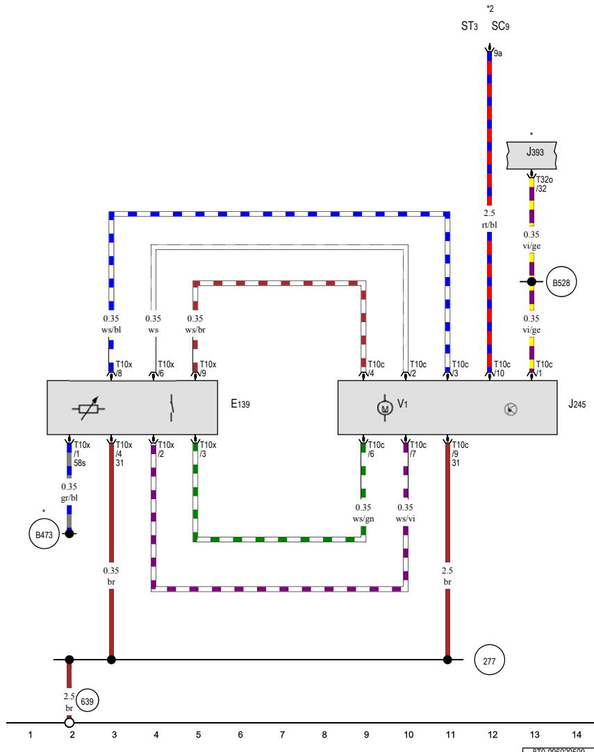
滑动天窗调节器, 滑动天窗控制单元, 舒适 / 便利功能系统的中央控制单元, 滑动天窗电机
